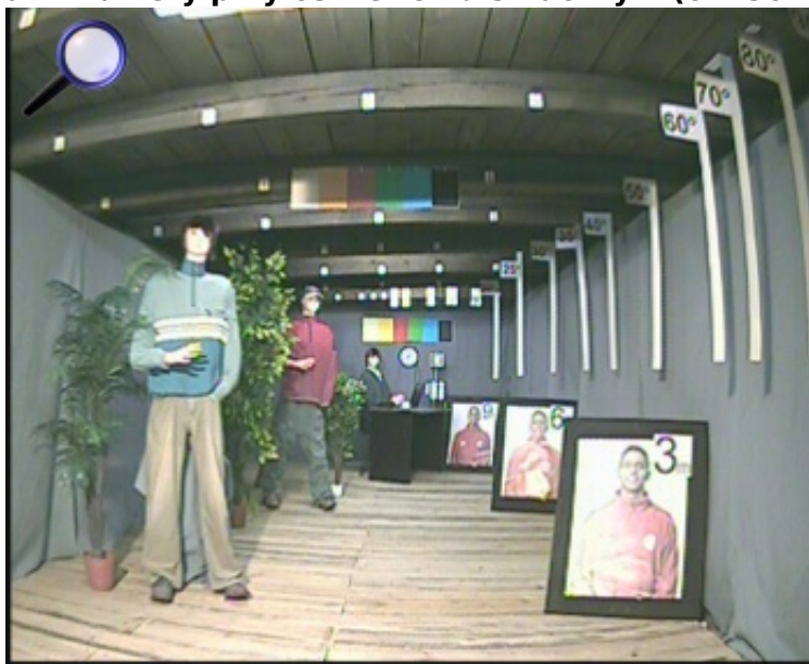
Obraz z kamery przy oświetleniu sztucznym (ok. 30 Lux):
