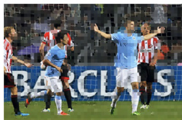
Odbiór TV - bez zabezpieczenia zakłóceń 4G LTE
